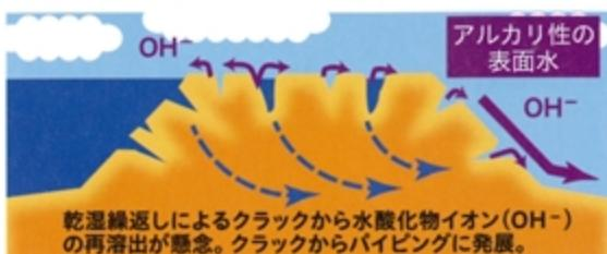
乾湿繰返しによるクラックから水酸化物イオン(OH<sup>-</sup>)の再溶出が懸念。クラックからバイピングに発展。
